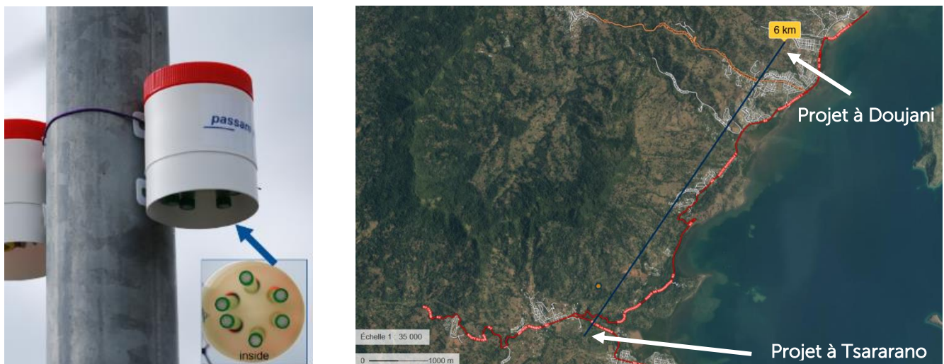
Figure 8. Dispositif de mesure du dioxyde d'azote utilisés sur un projet similaire à Tsararano
